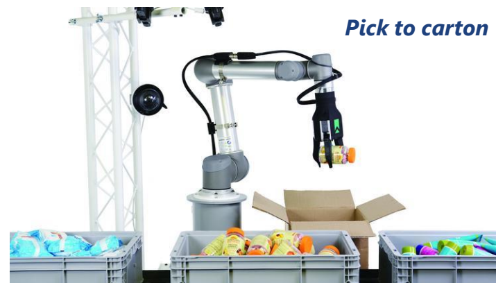
Baie di picking GTR ("Goods-to-Robot")
