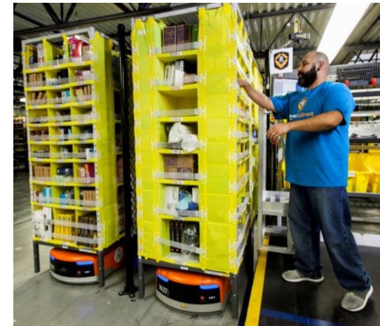
Sistemi "scaffale all'uomo"
